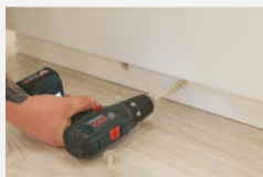
10 | PRZYKRĘCENIE BOKÓW DO DNA ZA POMOCĄ WKRĘTÓW 10 | SCREWING THE SIDES TO THE BOTTOM WITH SCREWS
